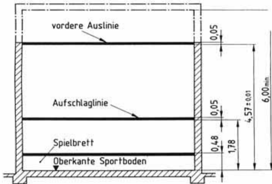
Bild 3. Schnitt mit Blick auf die Stirnwand
